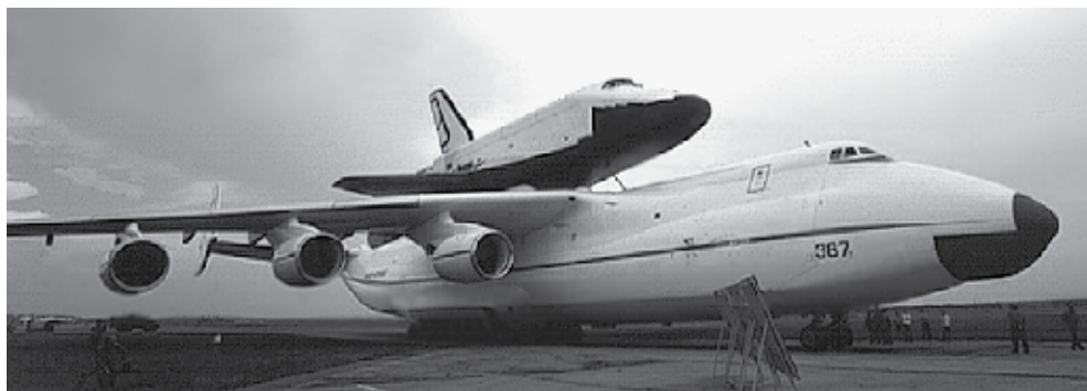
Сверхтяжелый самолет для перевозки крупногабаритных изделий (в частности, МКС «Буран») Ан-225 «Мрия»
